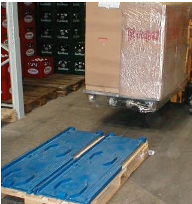
Abbildung 24 - Adapterpaletten der Firma Gebhardt und Container Centralen
