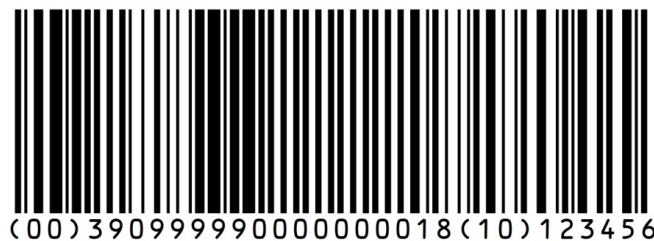
Abbildung 18 - Normiertes Logistiketicket mit GS1-128 Strichcodes und SSCC (empfohlenes Format A 6 oder höher)
