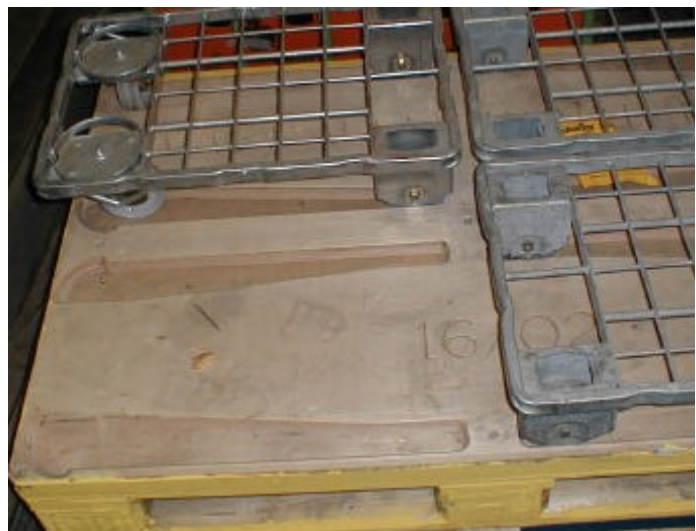
Abbildung 24 - Adapterpaletten der Firma Gebhardt und Container Centralen
